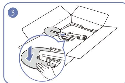
Закройте НИЖНЮЮ КРЫШКУ ЗАДНЕЙ ПАНЕЛИ. Приподнимите шейку подставки.
