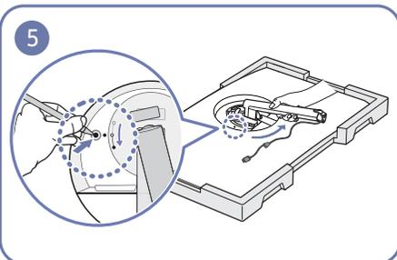
Вдавите тонкий стержень в отверстие для извлечения подставки и поверните подставку против часовой стрелки, как показано на рисунке.
