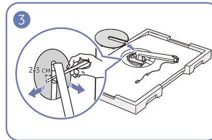
Демонтируйте и снимите ПЕРЕХОДНИК ЗАДНЕЙ КРЫШКИ.
