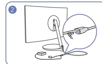
Подключите кабель адаптера постоянного/переменного тока к порту DC 19V кабеля HDMI (ГНЕЗДО +DC).
