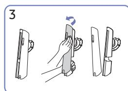
Удалите ЗАДНЮЮ КРЫШКУ СТОЙКИ ПОДСТАВКИ, потянув ее в направлении, как показано на рисунке.
