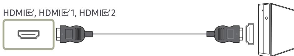
— Рекомендуется использовать кабель HDMI, входящий в комплект поставки. Если его нет в комплекте поставки, используйте разрешенный кабель для кабельных подключений через порт HDMI. При использовании неразрешенного кабеля HDMI качество изображения может ухудшиться.
