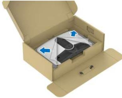
6. Осторожно вдвиньте выступы на подъемнике стойки в прорези на задней стенке дисплея и надавите вниз стойку в сборе, чтобы она со щелчком встала на место.
