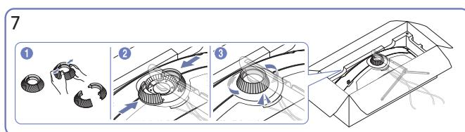
Демонтируйте ВЕРХНЮЮ ЗАДНЮЮ КРЫШКУ. Установите ВЕРХНЮЮ ЗАДНЮЮ КРЫШКУ к шейке подставки, как показано на рисунке. Поверните ВЕРХНЮЮ ЗАДНЮЮ КРЫШКУ по часовой стрелке.
