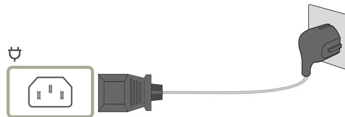
Для работы с устройством подключите кабель питания к электрической розетке и порту  $\oplus$  на устройстве.
