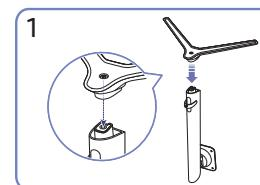
Поместите подставку в соединительный элемент, как показано на рисунке. Проверьте, надежно ли закреплен соединительный элемент подставки.
