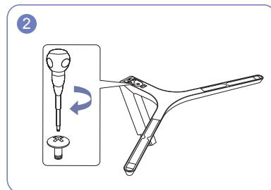
Полностью закрутите соединительный винт в нижней части подставки, чтобы как следует зафиксировать соединительный элемент.
