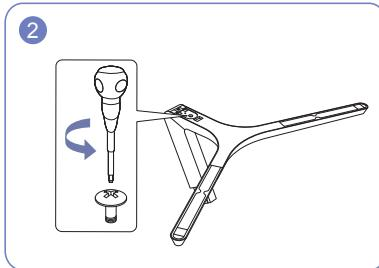
Открутите соединительный винт в нижней части подставки.
