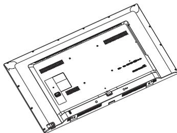
2. Прикрепите основание к нижней части монитора и закрепите его винтами.
