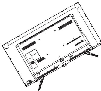
2. Ослабьте установочные винты, а затем отсоедините основание от монитора.
