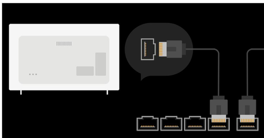
01 Подключите маршрутизатор к порту ЛВС телевизора с помощью кабеля ЛВС. Маршрутизатор необходимо предварительно подключить к Интернету.
