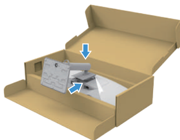
Рис. 14. Крепление подставки к дисплею
