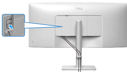
Рис. 22. Установка крышки боковой панели ввода/вывода
