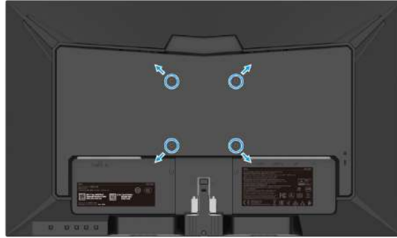
Рисунок 22. Настенный монтаж с помощью крепления VESA
