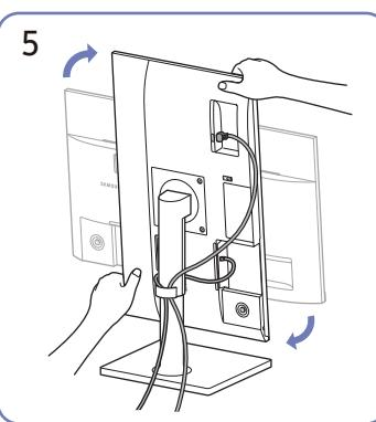
Поверните устройство в горизонтальное положение.
