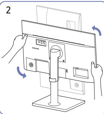
Поверните устройство в самое высокое вертикальное положение.
