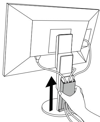
2. Слегка нажимая в месте ⠁ части (A), сдвиньте часть (A) вверх, чтобы отсоединить ее от стойки.
