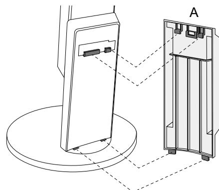
2. Сдвиньте часть (A) вниз, чтобы ее лапки зафиксировались на крепежных деталях стойки.
