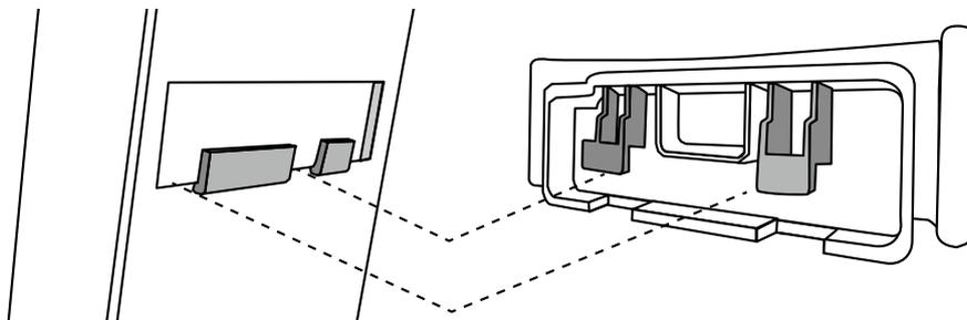
2. Чтобы закрепить держатель кабеля на стойке, сдвиньте его вправо.
