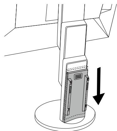
3. Проверьте лапки части (B) (четыре позиции, помеченные значком  $\diamond$ ) и крепежные позиции части (A).
