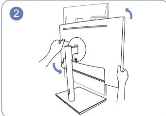
Поверните устройство в самое верхнее вертикальное положение.
