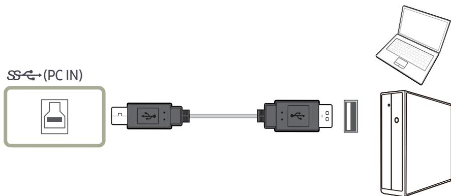
Подключите кабель USB к порту на задней стороне устройства и к порту USB на ПК.
