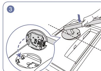
Поместите соединительный элемент на дисплей, как показано на рисунке. При размещении соединительного элемента следите, чтобы два выступа на нем встали в пазы на дисплее. Надавите на соединительный элемент, пока приподнятая кнопка на нем не вставится в паз на дисплее.
