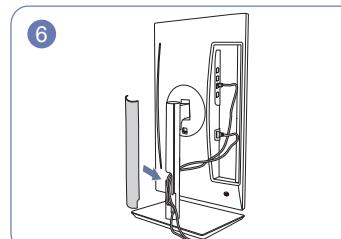
Закройте КРЫШКУ СОЕДИНИТЕЛЬНОЙ ДЕТАЛИ.
