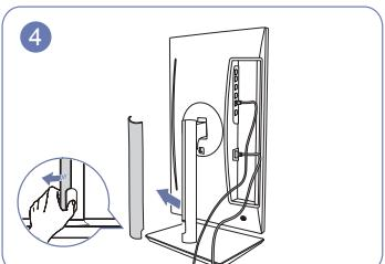
Откройте КРЫШКУ СОЕДИНИТЕЛЬНОЙ ДЕТАЛИ В ПРАВО и поверните открытую часть снизу.
