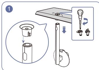
Вставьте соединительный элемент в подставку, как показано на рисунке. Полностью закрутите соединительный винт в нижней части подставки, чтобы как следует зафиксировать соединительный элемент.
