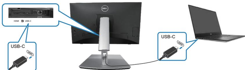
**📎 ПРИМЕЧАНИЕ.** Используйте кабель USB-C (C-C), поставляемый в комплекте с монитором.
