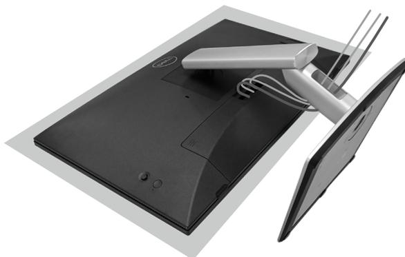
Установка крышки кабеля:
