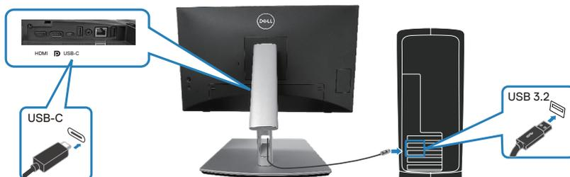
**ПРИМЕЧАНИЕ.** Сенсорный ввод работает только в том случае, если кабель для передачи данных подключен к восходящему порту USB-C монитора и к компьютеру с помощью входящего в комплект кабеля USB C-C или USB C-A.
