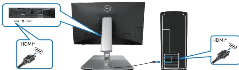
HDMI\* = поддерживает разрешение до FHD 1920 x 1080 при 60 Гц, как указано в HDMI 1.4.
