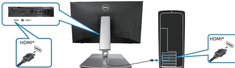
HDMI\* = поддерживает разрешение до FHD 1920 x 1080 при 60 Гц, как указано в HDMI 1.4.
