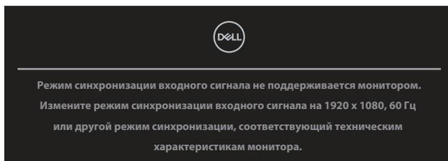
Это означает, что монитор не может произвести синхронизацию с получаемым от компьютера сигналом. Доступные для данного монитора диапазоны частот горизонтальной и вертикальной разверток представлены в разделе «Технические характеристики монитора» . Рекомендуемое разрешение **1920 x 1080**.
