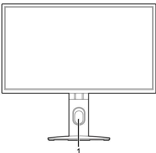
1. Отверстие для укладки кабелей
