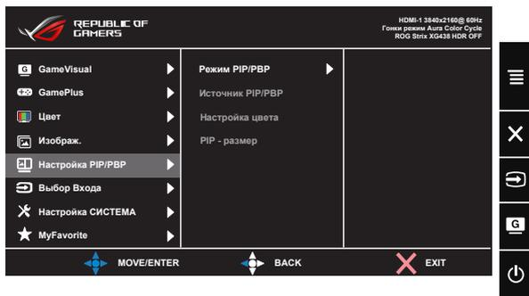
При включении данной функции на мониторе отображаются два, три или четыре изображения от различных источников видеосигнала.
