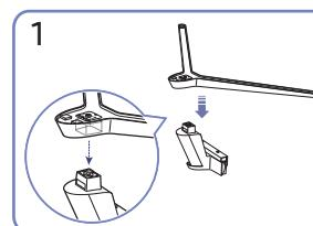
Поместите подставку в соединительный элемент, как показано на рисунке. Проверьте, надежно ли закреплен соединительный элемент подставки.
