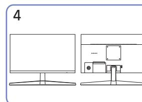
Постелите на стол мягкую ткань, а на нее экраном вниз положите устройство. Вставьте собранную подставку в корпус в направлении стрелки, как показано на рисунке. Полностью закрутите соединительный винт в нижней части корпуса.
