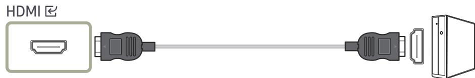
— Используйте только кабель HDMI, входящий в комплект поставки устройства. При использовании кабеля HDMI другого производителя качество изображения может ухудшиться.
