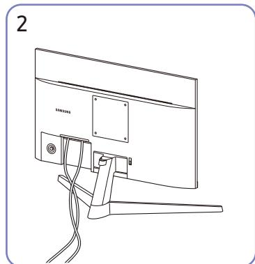
Наклоните дисплей, как показано на рисунке. Подключите соответствующие кабели.
