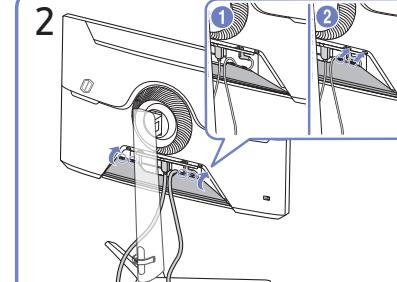
Расположите кабели, учитывая сгибающую способность, и извлеките кабели из НИЖНЕЙ КРЫШКИ ЗАДНЕЙ ПАНЕЛИ.
