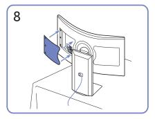
Закройте заднюю крышку для завершения на процесса.
