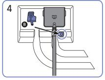
Вставьте кабельный держатель в отверстие, чтобы зафиксировать кабели.
