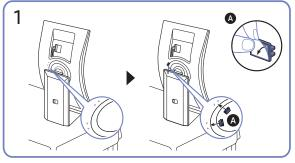
Прикрепите кабельные направляющие к канавке на задней панели монитора.
