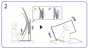
Для переключения монитора в горизонтальную ориентацию поднимите опорную стойку на максимальную высоту, а затем поверните монитор по часовой стрелке.
