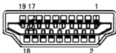
19-контактный кабель для передачи сигналов цветного изображения
