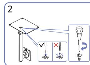
Полностью закрутите соединительный винт в нижней части подставки, чтобы как следует зафиксировать соединительный элемент. Затяните большой винт в середине, чтобы собрать конструкцию вместе.
